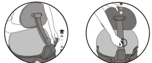
Remontez la manette pour ajuster et la descendre pour verrouiller. La molette permet de régler la hauteur du dossier en la desserrant, puis en la resserrant pour maintenir la position.
