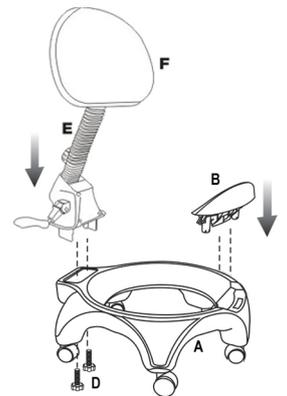
b) Installez le support avant (B) dans le socle (A).
